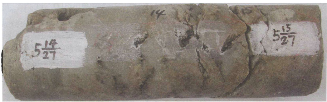
图2 塔深1井岩心中的溶蚀孔洞和裂缝(8 407 m)
